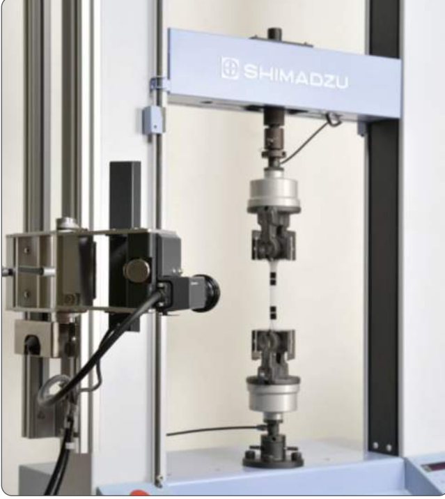
AGS-10kNXD + Pnömatik Düz Kavrama + TRViewX Temassız Dijital Video Ekstensometre
