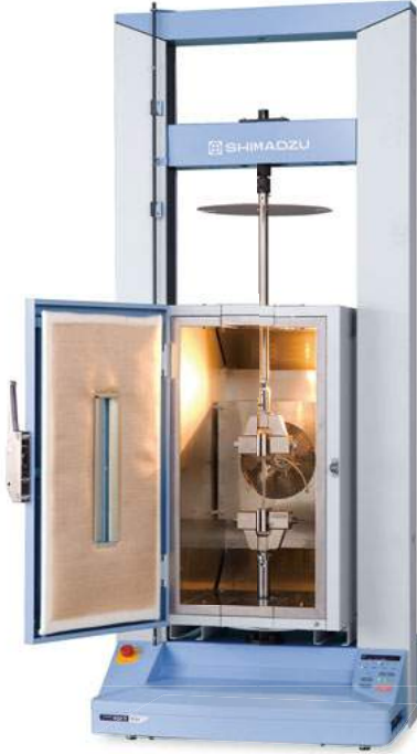
AGS-10kNXD + Vidalı Düz Kavrama + Kompakt Termostatik Oda TCE serisi
