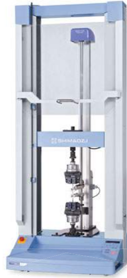
AGS-10kNX + 1kN Paralel Sıkma Kancaları + Yumuşak numuneler için SES-1000 Ekstensometre
